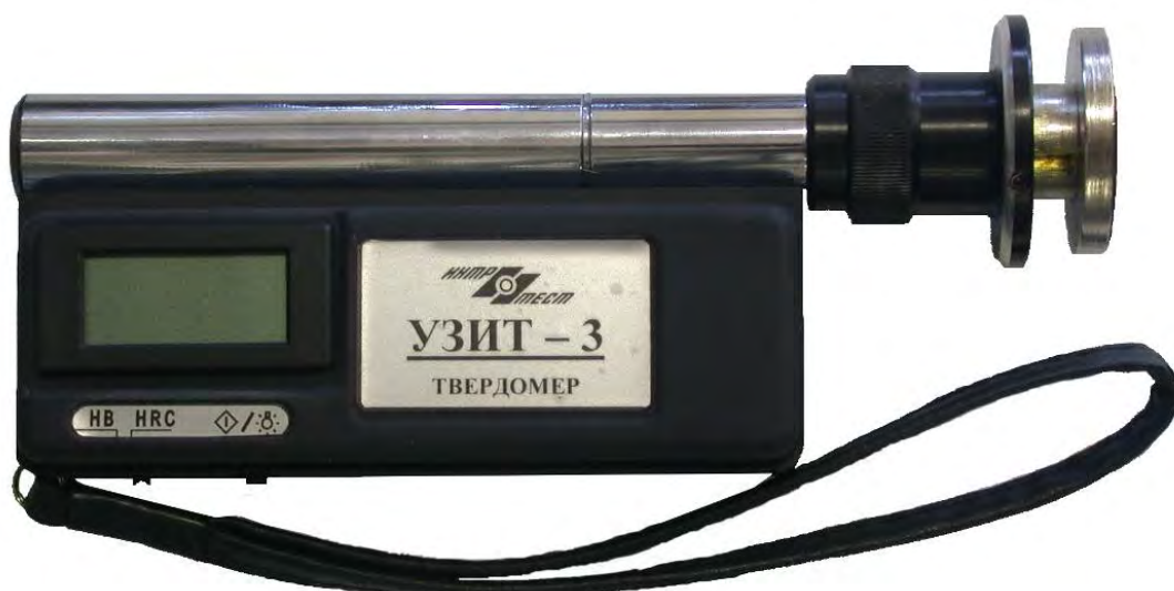
Рисунок 1 - Общий вид измерителя твердости УЗИТ-3.
